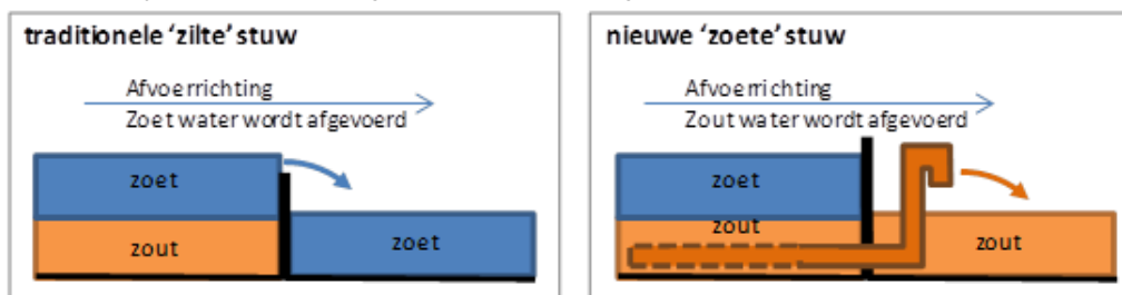
Figuur 3-1. Traditionele stuw (links) en zoete stuw met drain (rechts)
